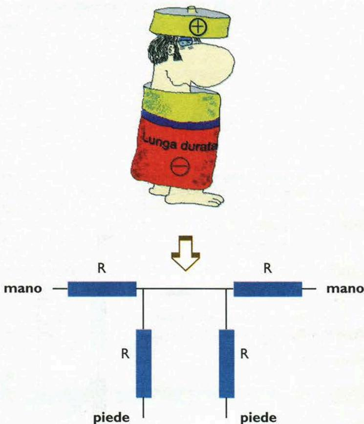
La figura soprariportata costituisce sostanzialmente lo schema elettrico equivalente del corpo umano.
