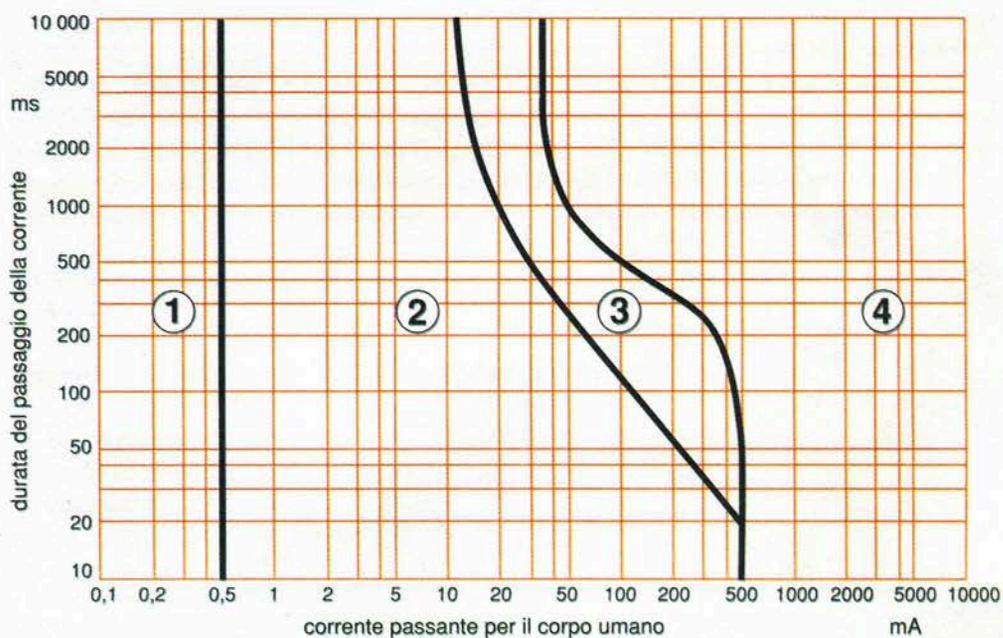
Il diagramma, chiamato curva di sicurezza, riporta in orizzontale i valori della corrente espressi in **mA** (millesimi di ampere), in verticale il tempo di circolazione della corrente in **ms** (millesimi di secondo).
