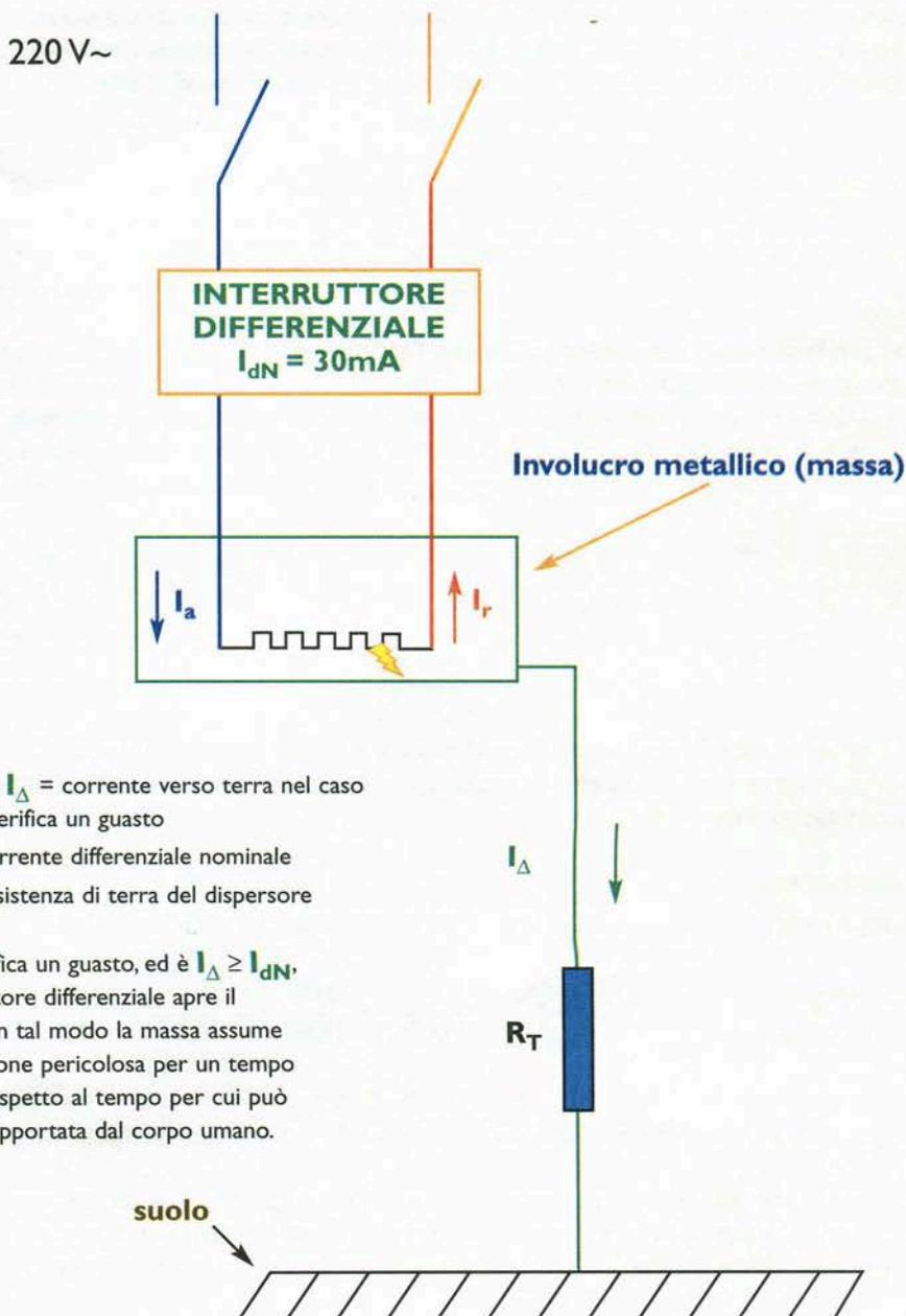
Nei sistemi alimentati in bassa tensione (TT), che sono quelli tipicamente presenti negli ambienti di lavoro del settore terziario, la protezione si realizza attraverso una corretta scelta dell'interruttore differenziale e un corretto dimensionamento dell'impianto di terra. Tali condizioni (*coordinamento tra interruttore differenziale e impianto di terra*) si verificano se è soddisfatta la seguente relazione:
